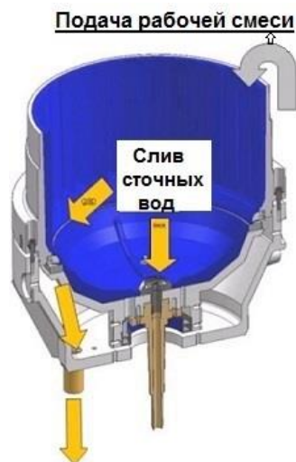
Контейнер с зазором 0,4 мм
