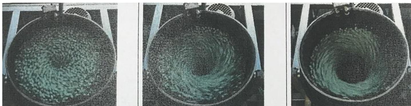
Избыточное количество наполнителя
